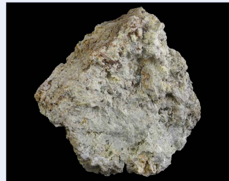
Fig. 1 - Scoria di fusione proveniente dalla miniera del Tafone contenente clinocervantite, rosiaite, valentinite, tripuhyite e bindhemite. Dimensioni 12 x 12 x 10 cm; peso Kg. 2.116; collezione e foto L. Ceccantini.
